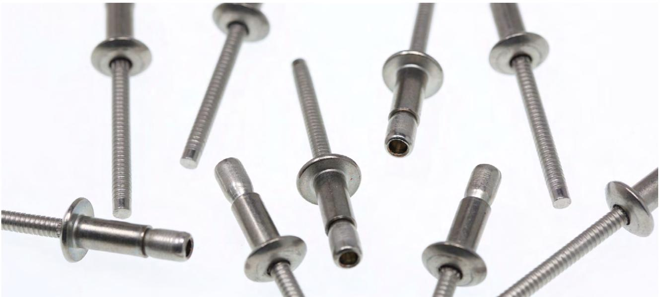
Ein hochfester Blindniet für einen festen Sitz auch bei dynamischer Beanspruchung. Bei entsprechender Bohrlochvorbereitung sind die Verbindungen wasser- und luftdicht. Der Abriss des Nietdorns erfolgt immer bündig, auch bei unterschiedlichen Materialstärken innerhalb des Klemmbereiches. Die Schließkopfauflage auf der Blindseite ist minimal. Das Klemmlängenspektrum ist groß. Auch in Edelstahl A4 erhältlich.
