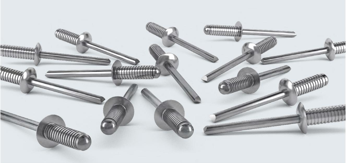
Die TIFAS® Grooved Blindniete eignen sich zur Vernietung in Sacklöchern in weichen Werkstoffen und für die Verarbeitung in Holz- und Kunststoffanwendungen. Sie findet Anwendung in der Möbelindustrie, im Innenausbau, in der Holz- und kunststoffverarbeitenden Industrie, im Karosseriebau und vielem mehr. Die aufgebraute Rillierung krallt sich formschlüssig in die Laibung des der Bohrung umgebenden Materials.
